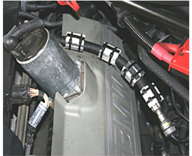
燃料フィルターから出ている（無い場合もある）ゴムホース、金属管を洗浄液スプレーなどで綺麗にして下さい。その上からバンド状のチップを両面テープで粘着させ、付属のバンドでしっかり留めてください。
